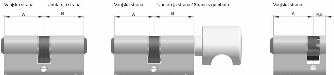
Ispravna duljina cilindra određuje se prema debljini vrata plus debljina montirane rozete ili štita (ovisno o modelu ugrađene kvake).
